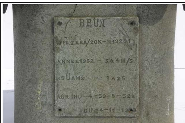
Particolare dell'incisione riportante i dati di costruzione della dinamo.
